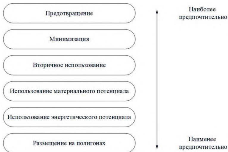
Рис. 6. Иерархия обращения со строительными отходами
