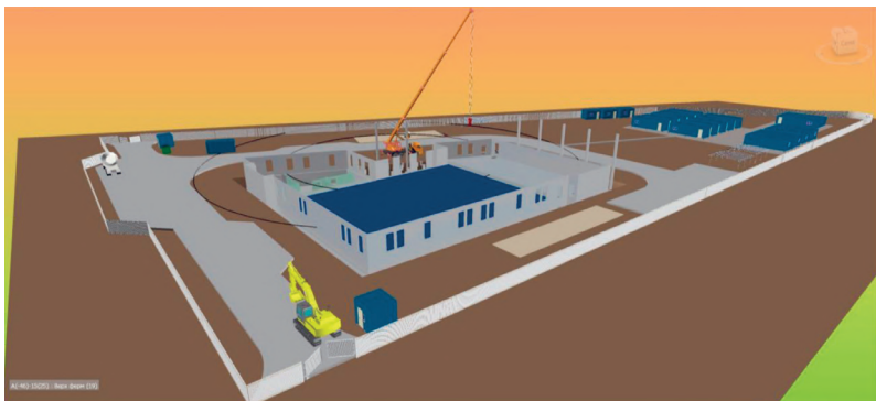
Рис. 3. 4D-анимация строительства спортивного комплекса в Autodesk Navisworks
