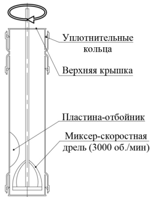
Рис. 2. Смесительная установка для приготовления суспензии
