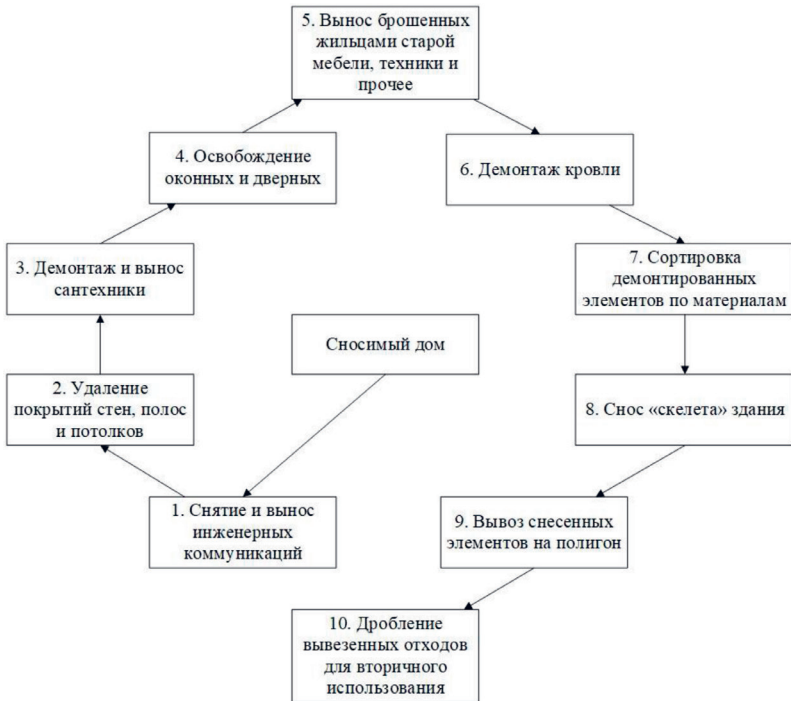
Рис. 8. Последовательность процессов технологии «умный снос»
