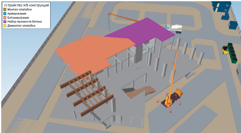
Рис. 2. 4D-анимация строительства транспортно-пересадочного узла в SYNCHRO Pro
