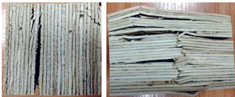
Рис. 2. Фотографии образца № 12 с размерами 75×75×135 мм после испытания на сжатие вдоль волокон со скоростью нагружения 60 мм/мин
