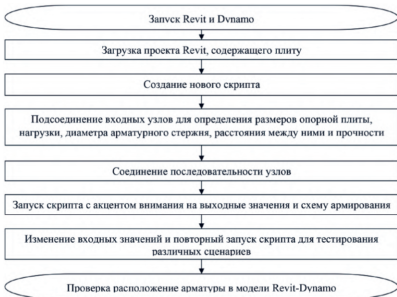
Рис. 2. Процесс тестирования алгоритма в Revit
