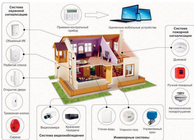
Рис. 3. Взаимодействие элементов «Умного дома»
